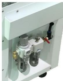
4. 請將搭配快速接頭的壓縮空氣風管裝入快速接頭插入口並調整壓力到 5KG/CM<sup>2</sup>- 7KG/CM<sup>2</sup> 範圍內(如下圖紅圈內)
